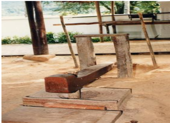
Rajah 1.20: Lesung hindik ini boleh didapati di kampung-kampung. Ia diperbuat daripada kayu yang tahan lama. Ia terdiri daripada ibu yang ditanam dalam tanah manakala alunya dibuat bentuk memanjang serta dilengkapi dengan pemegangnya. Lesung ini digunakan untuk menumbuk padi dan beras. Caranya dengan menggunakan kaki untuk memijak dihujung alunya.
